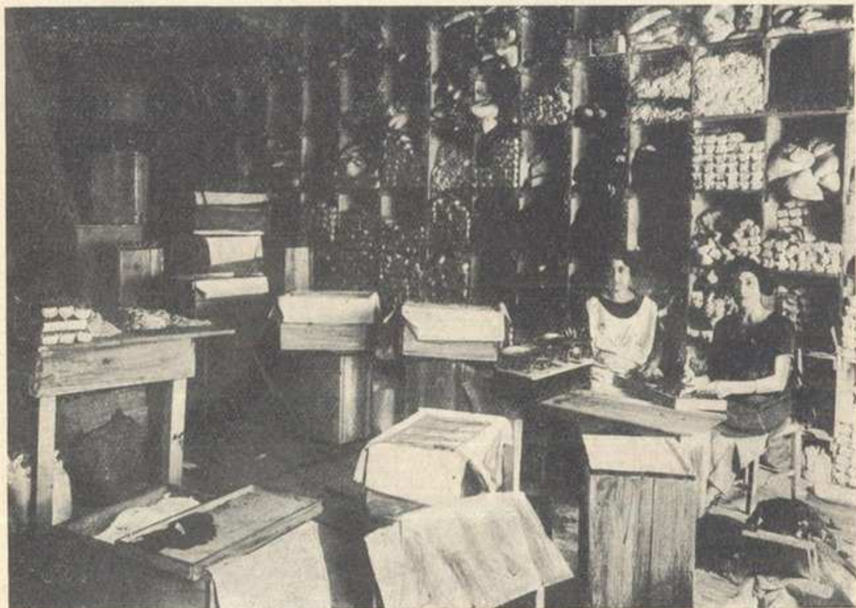
Magazyn fabryczny. Robotnice odważają i pakują do skrzyń nawleczone paciorki
